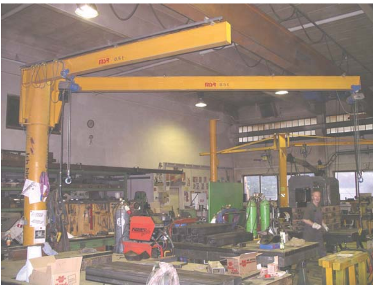
Säulen-Doppelschwenkkran mit je 500 kg Tragfähigkeit, hoher Hub
