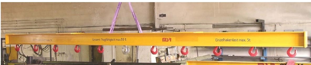
Mehr-Haken-Traverse für 2-strg. Aufhängung zum Kranhaken, Tragfähigkeit 10 t., Einzelhaken Tragfähigkeit 5 t.
