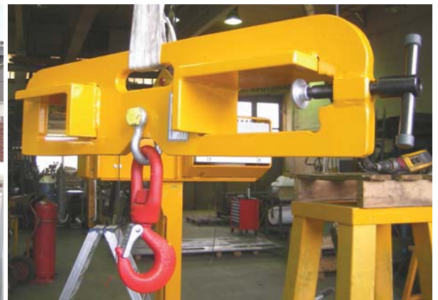
Stapler-Traverse mit drehbarem Mittelhaken 2,5 t.
