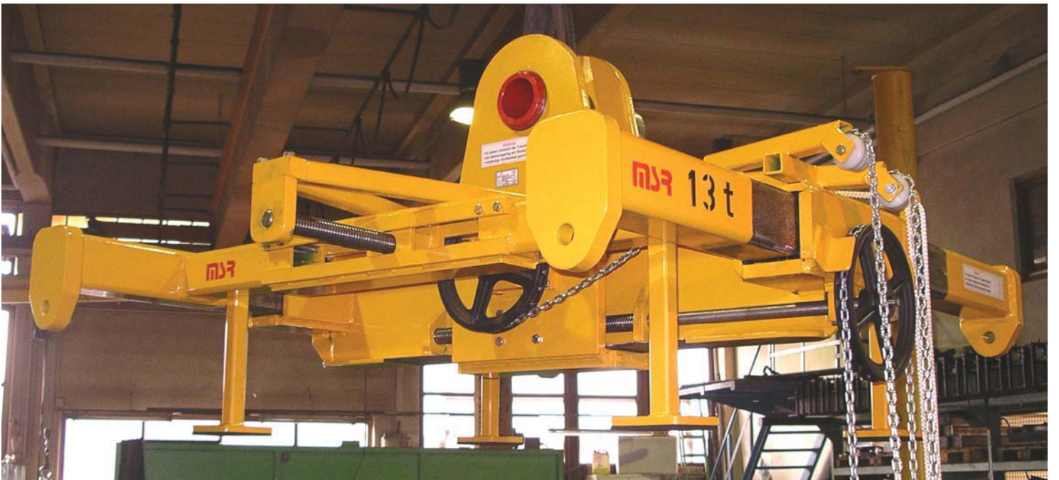
Sonder-Ausleger-Traverse 13 t., mit verschiebbarer Aufhängung in Längs- und Querrichtung über Spindeltrieb und Handrad. Steckbolzen über Seilzug ver- und entriegelbar.
