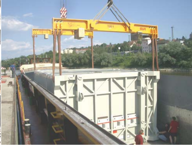
Schwerlast-Traversen 100 t. für den Transport, Verladung und Aufstellung von Cold-Boxen
