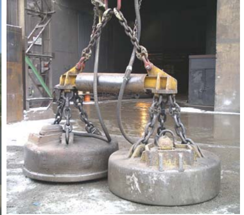
Magnet-Traverse 25 t. für Schrottverladung
