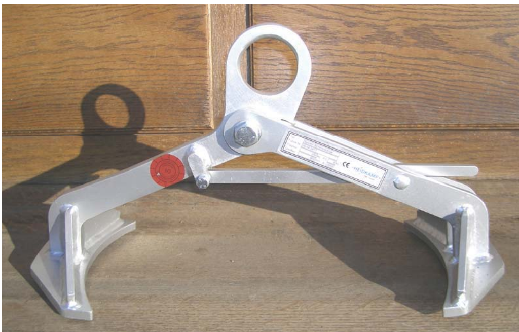
Unten rechts: Sonderzange mit Parallelführung und Schrittschaltwerk zur Aufnahme und Transport von Alu-Gußteilen.
