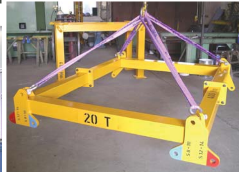
Maschinentraverse für BZ 20 t.
