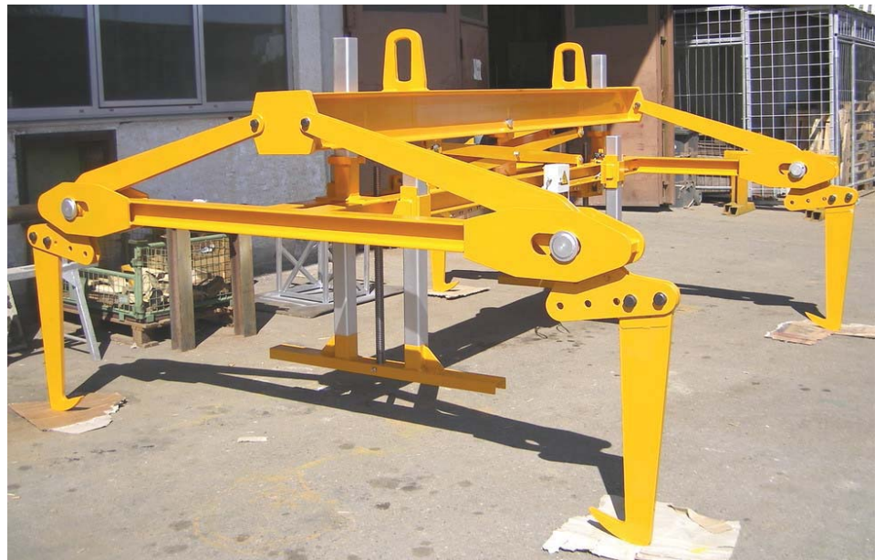
Unten rechts: Baustahlmattenzange mit elektromechanisch höhenverstellbarem Aufsetzer. Zusätzliche Breitenverstellung über Steckbolzenverbindung (Zangenarme).
