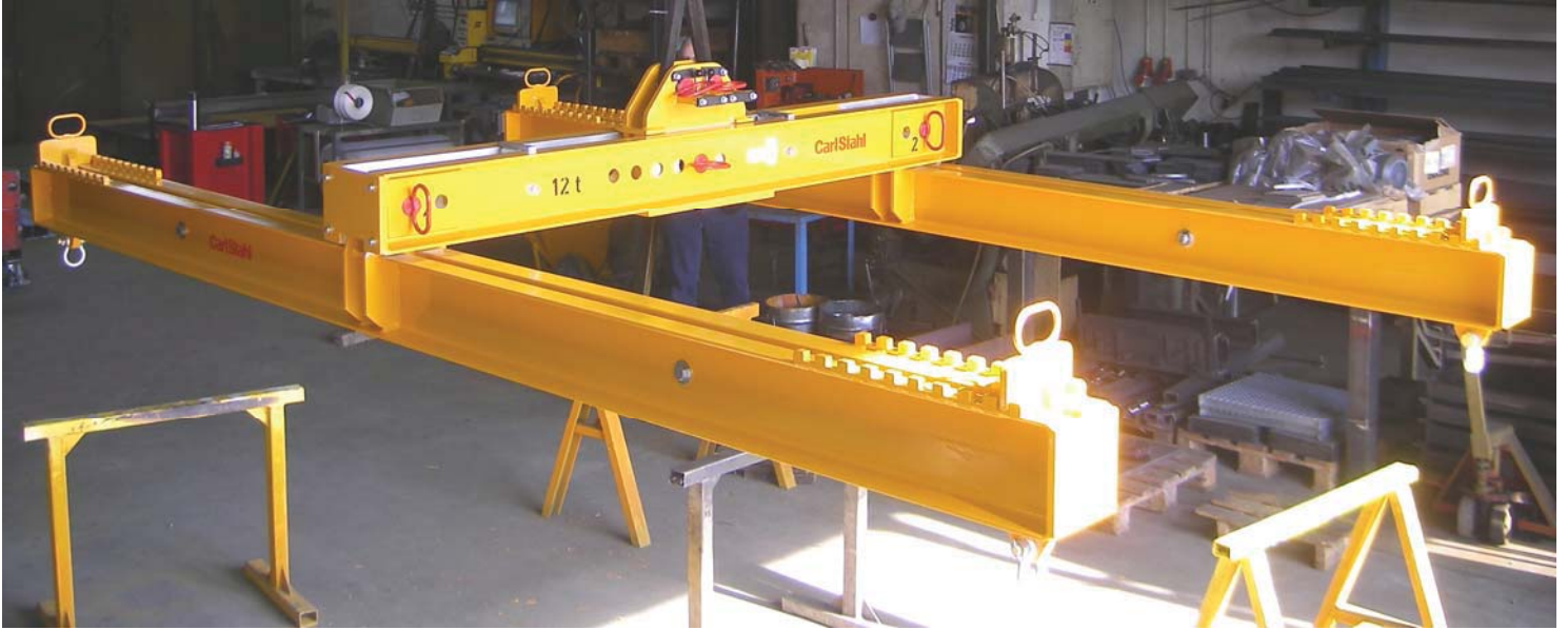
Sonder-Ausleger-Verstell-Traverse 12 t. zum Transport von verschiedenen Maschinentypen, Traversen auch einzeln nutzbar,
