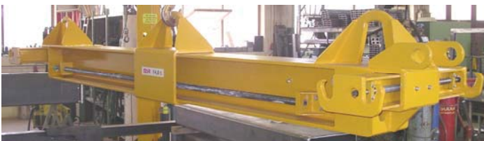
Traverse mit verschiebbarer Aufhängung + verschiebbaren Quertraversen manuell über Spindelverstellung und Handkurbel
