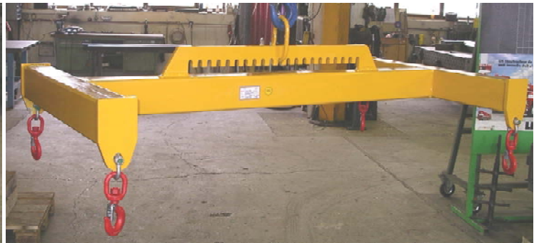
Ausleger-Traverse mit verstellbarer Aufhängung im Raster
