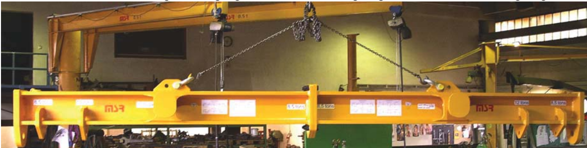
Kombi-Traverse für verschiedene Cold-Boxen, max. 80 t. Außenseiten in Verbindung mit den Aufnahmepollern.
