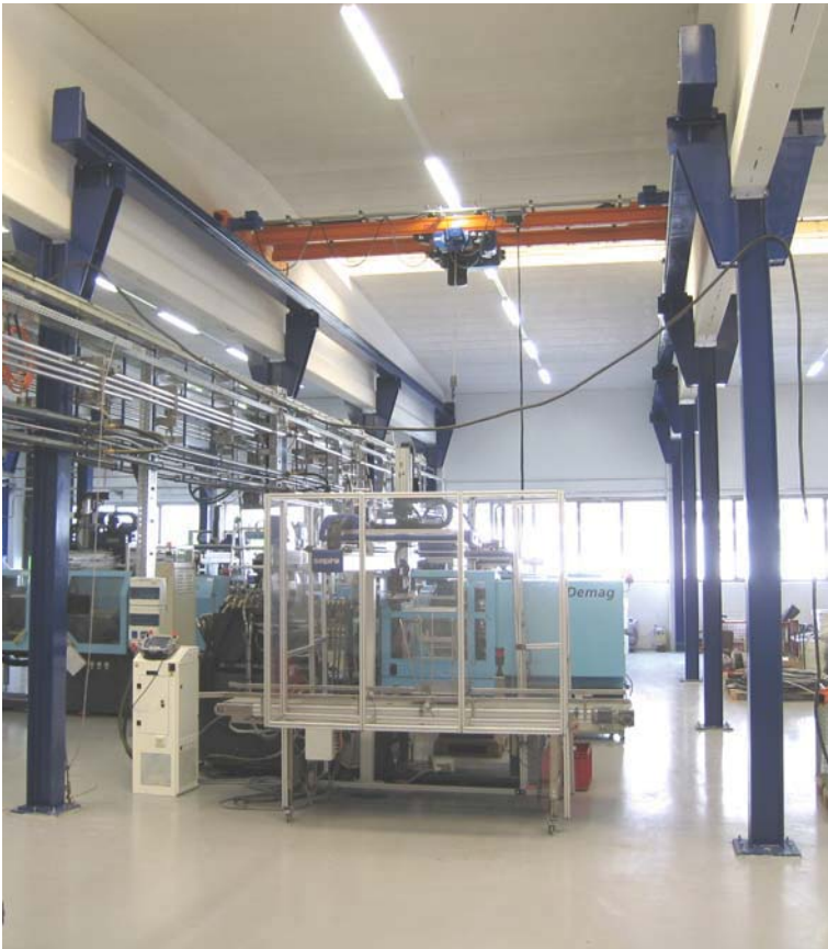
Sonderkrananlage mit Kettenzug, elektr. verfahrbar.
