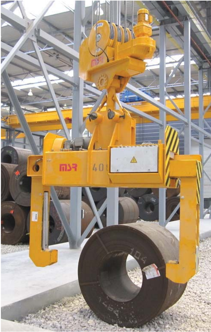
Teleskop-Coilzange mit drehbarer Unterflasche, + Zusätze
