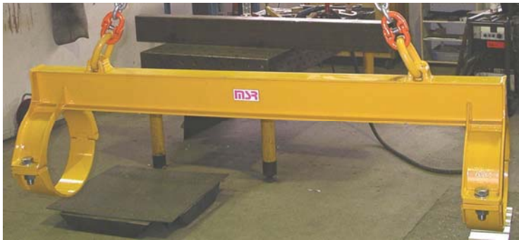
Traverse mit Klemm-Schellen für den Walzenaus- und einbau
