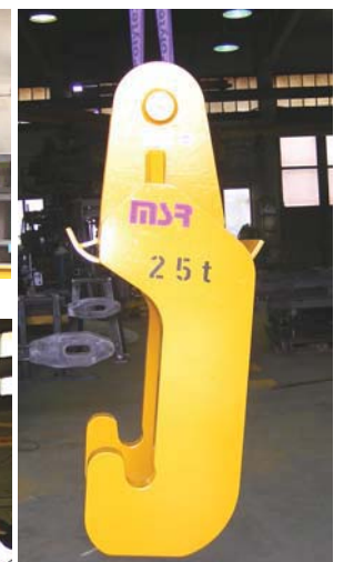
Langhaken-Traverse für Gießerei (Heißeinsatz) zum Transport von Ofeneinsätze mit Last.
