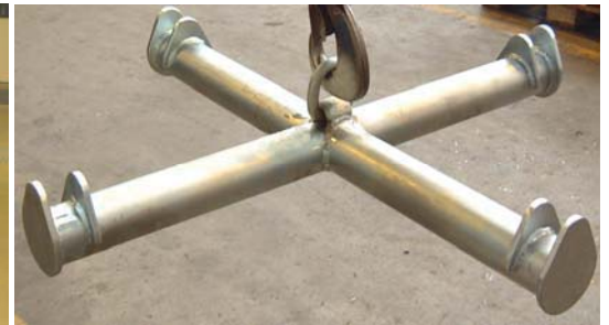
Oben: BigBag-Traverse in Rohrausführung Links: Rahmentraverse mit zentraler Steck-Bolzen-Verriegelung
