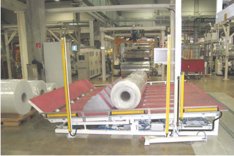
Rollen-Entsorgung (Tisch mit 16 Einzelklappen, 2 Ebenen) in elektropneum. Ausführung. Lichtvorhang zur Sicherheit gegen Eingreifen.
