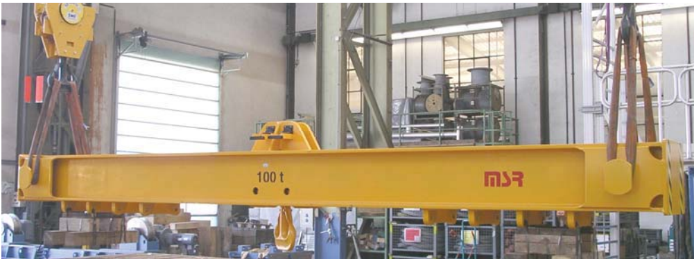
Kombi-Schwerlast-Traverse 100 t. mit drehbarem Mittelhaken und Aufhängepollern
