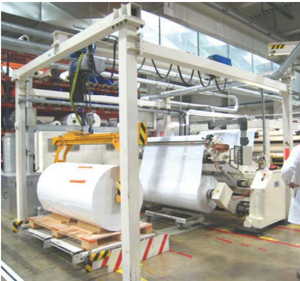
Sonderkrananlage mit Kettenzug, elektr. verfahrbar.
