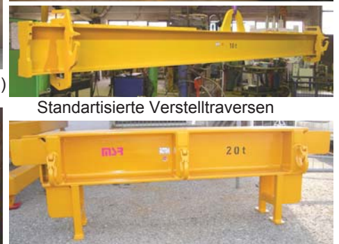
Zwischen-Traverse für Teleskop-Coilzangen 20 t. mit Anschweißhaken zur Lastaufnahme
