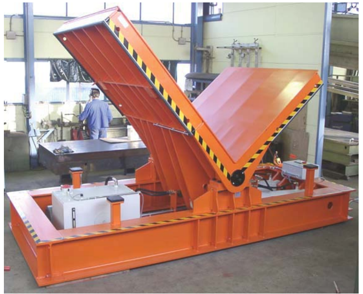
Oben links: Scheiben-Wendetisch in elektromechanischer Ausführung.
