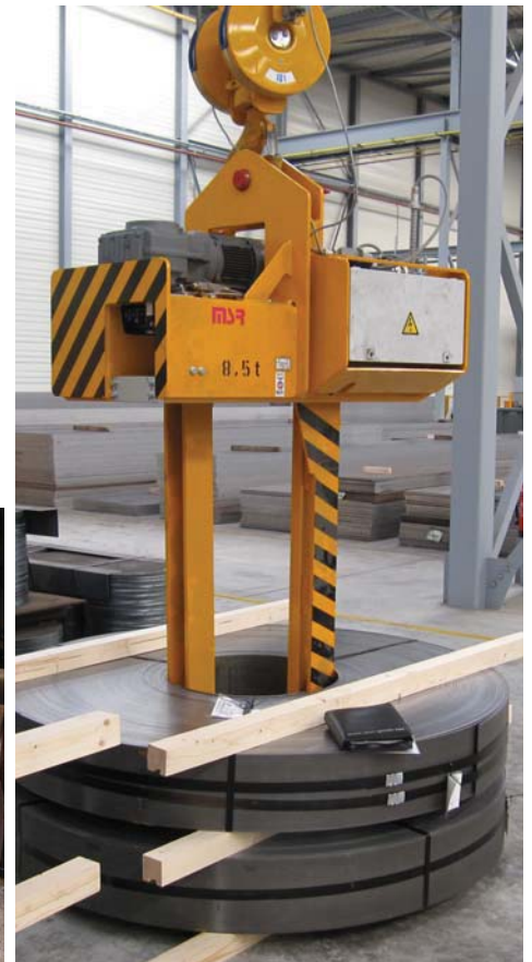
Teleskop-Coilzange mit Drehwerk fest eingesichert, + Zusätze
