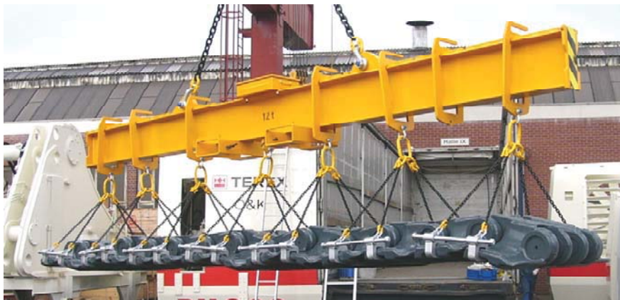
Verstelltraverse mit Kettengehänge zum Transport von Panzerketten mit Sonderaufnahmen für die Panzerketten.
