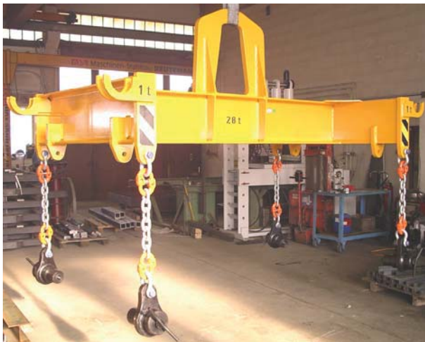
Rahmen-Traverse mit Sonderaufnahmen f. Walzenstöcke
