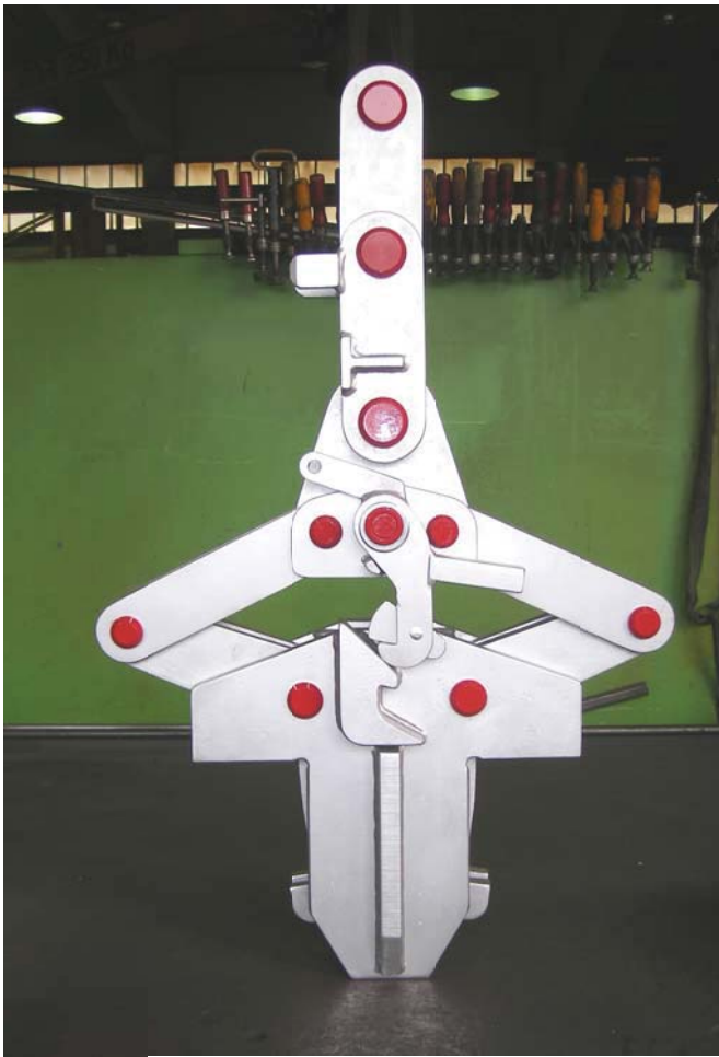
Oben: Schereninnenzange für Ventilatorengehäuse mit Zwangsführung, autom. Offenhalter.
