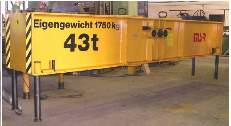
Schwerlast-Traverse 43 t. mit Steckbolzen und einfahrbaren Standfüßen
