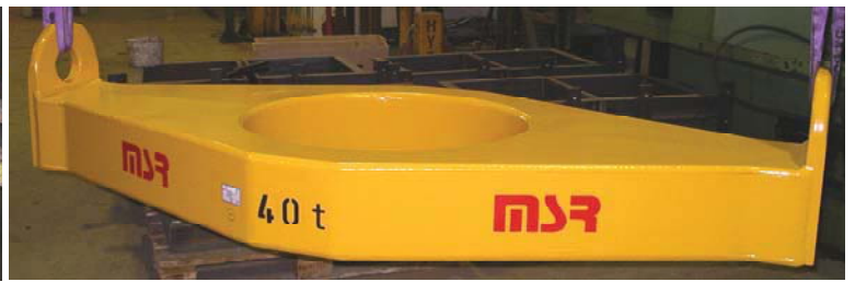
Schwerlast-Traverse für Preventer 40 t.
