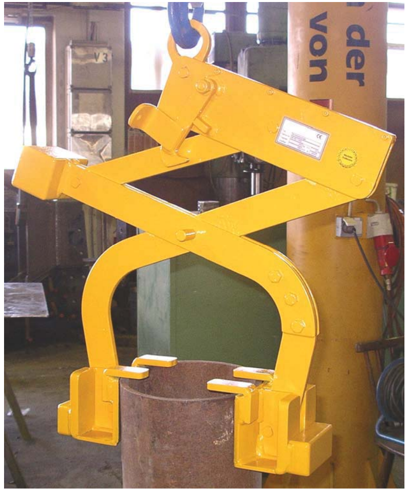
Oben: Schereninnenzange für Ventilatorengehäuse mit Zwangsführung, autom. Offenhalter.
