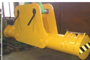
Sondertraverse mit Sicherung der gerundeten Seilauflagen
