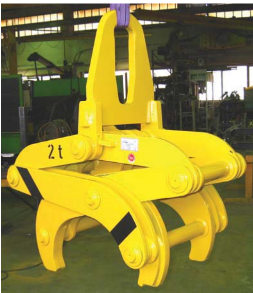
Links: 7-Bolzen-Rundmaterial-Greifer in schwerer Hüttenwerksausführung
