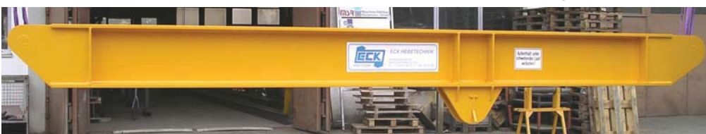
Koppeltraverse für 2 Krane mit asymmetrisch angeordnetem Lastaufnahme-Steckbolzen (65 t.)
