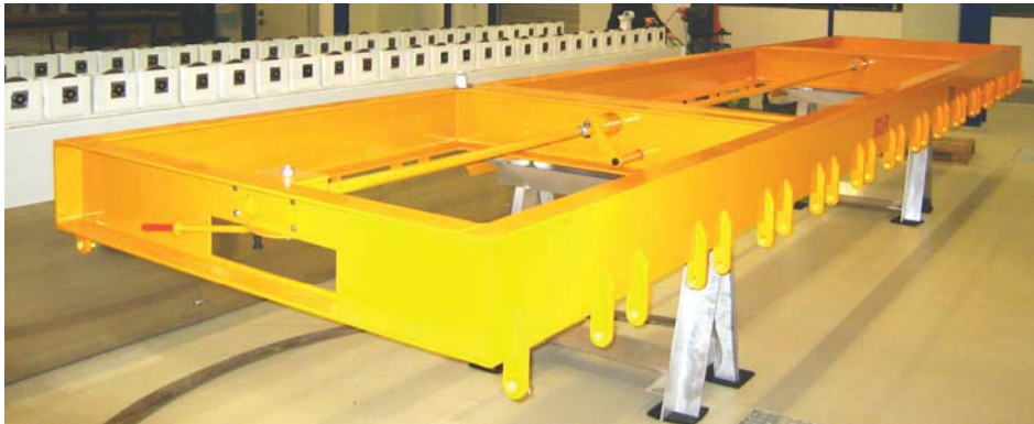
Rahmen-Traverse mit Sonderaufnahmen f. Walzenstöcke
