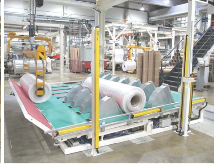
Rollen-Entsorgung (Tisch mit 16 Einzelklappen, 2 Ebenen) in elektropneum. Ausführung. Lichtvorhang zur Sicherheit gegen Eingreifen.
