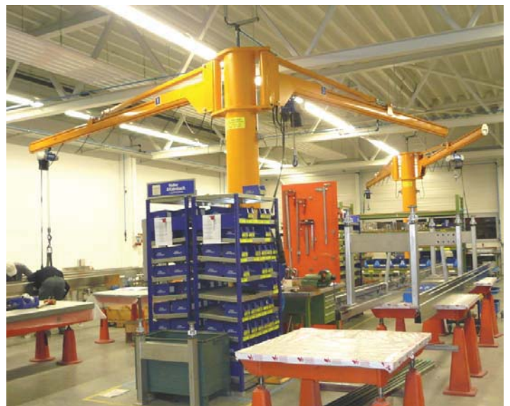
Säulen-Doppelschwenkkrane mit je 2 x 500 kg Tragfähigkeit
